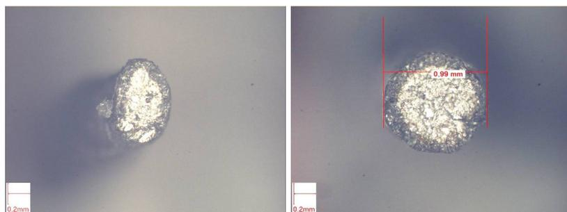
Figure 3 : Différence de morphologie entre un fil usée et un neuf.
