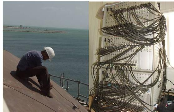
Figure 3 : Montage et vérification de la sensibilité des capteurs par un opérateur qualifié – Système VALLEN AMSY-5 104 voies
