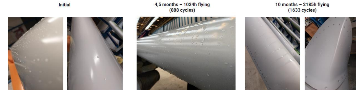
Photographie des ailes (et évaluation de la mouillabilité) après dépôt, après 1024 heures de vols et après 2185 heures de vol.
