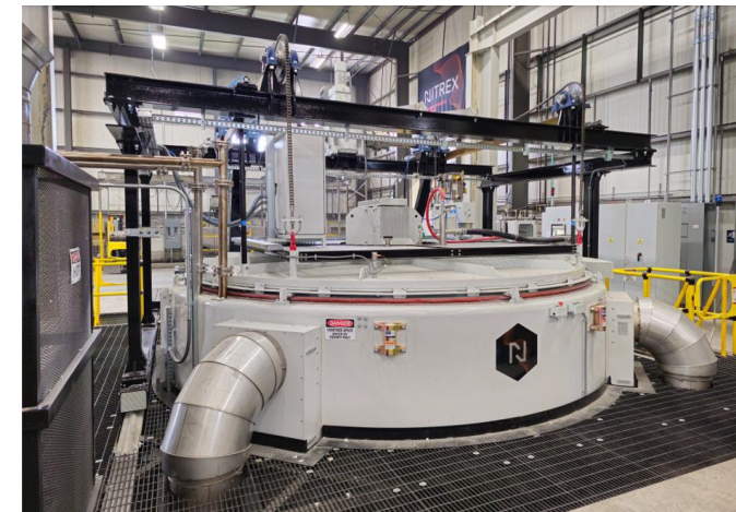
Exemple de fours de nitruration pour engrenages de grande taille: éoliennes, turbines à vapeur pour centrales nucléaires ou propulsion marine (charge de \Phi 4500 mm x 3500 mm de haut, 27 t)
