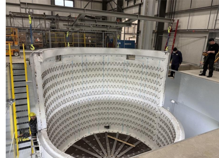
Exemple de fours de nitruration pour engrenages de grande taille: éoliennes, turbines à vapeur pour centrales nucléaires ou propulsion marine (charge de \Phi 4500 mm x 3500 mm de haut, 27 t)
