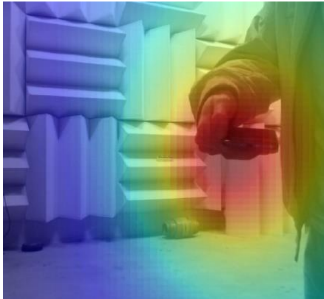
Figure 49 Exemple de résultat d'imagerie acoustique en temps réel (algorithme MUSIC, source sinusoïdale à 1kHz)
