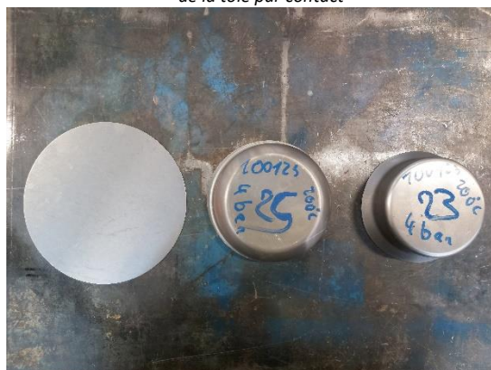
Figure 8 Différentes étapes d'emboutissage. A gauche le flan initial, au milieu le flan embouti après l'OP 20 et à droite la pièce finale
