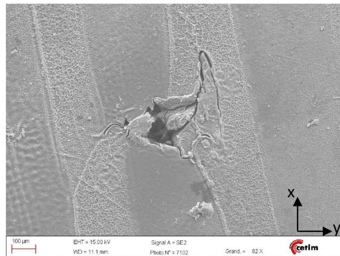
Figure 66 – Cliché MEB d'une surface polie du PEEK après attaque chimique
