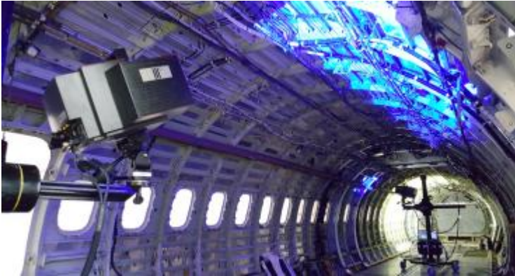
La mesure sur site de pièces de grandes dimensions
