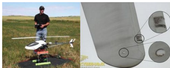
Détection de défauts sur une pôle d'éolienne par un UAV
