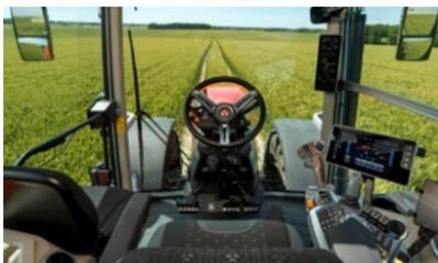
Le vitrage d'une cabine d'engin agricole est un élément clé, constitué de trois vitrages d'une surface totale de 4m<sup>2</sup>. Il doit permettre de faciliter la vue de l'environnement de travail de l'agriculteur mais peut aussi être un support pour diffuser de l'information, qui à l'heure actuelle est diffusée sur un écran déporté. Le challenge peut s'orienter suivant deux directions :
