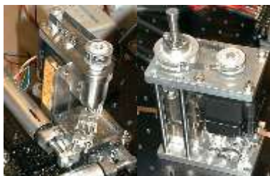
Micro-fraiseuse et Micro-presse, AIST
