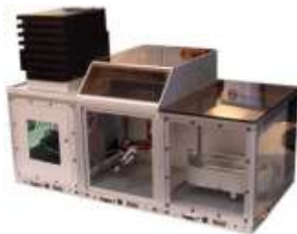
Fabrication d'implants auditifs, TUT Microfactory
