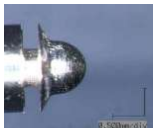
Exemple de réalisation d'un micro-chapeau en bout de tige de quelques dixièmes de mm., AIST
