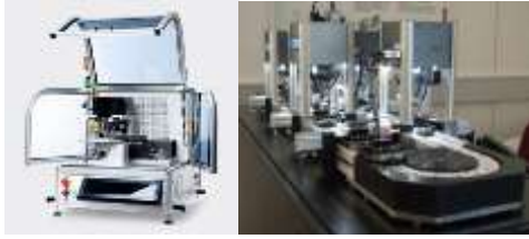
Cellule de palettisation et ligne d'assemblage, Asyrl
