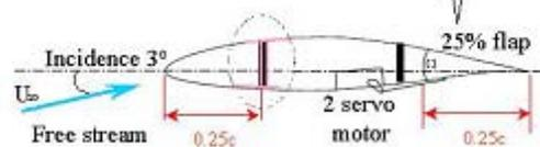
Fig. 10 : schéma du test de Fiberpro [6]
