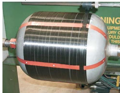
Fig.8 : exemple d'utilisation de SMART Layer sur un réservoir en composite<sup>[4]</sup>
