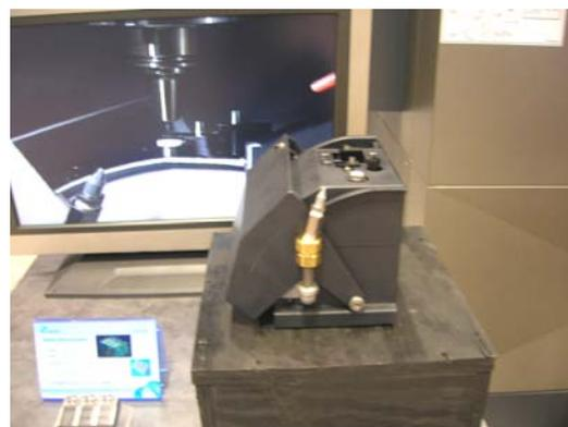
Figure 8 - Machine de grande précision IQ300 et système de mesure HyATLM
