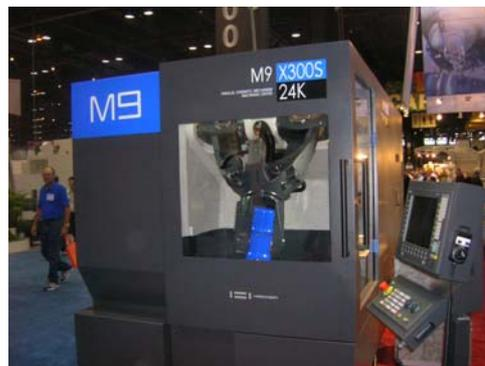
Figure 2 - Machine à structure parallèle M9-X300S
