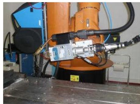
Pour la partie MIG/MAG, une source de 450 A associée à une torche refroidie par fluide générateur permettent d'utiliser des fils de métal d'apport de diamètre 0,8 à 1,6 mm.
