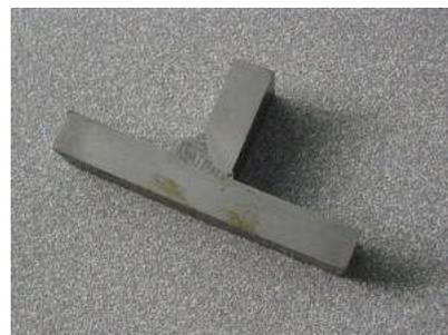
*Soudure en T de deux plaques d'acier de 12 mm d'épaisseur réalisée à 0,6 mètre/min en combinant un faisceau laser de 5000 W avec un arc MIG/MAG.*
