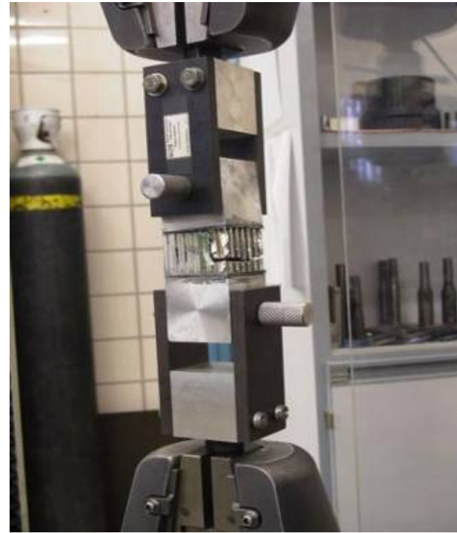
Essai « carré Fokker » pour caractérisation de la traction sens 3 (épaisseur)
