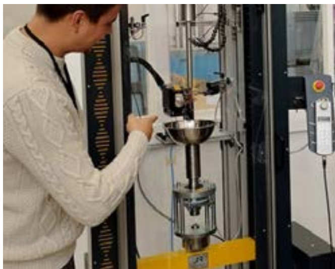
Dédiée à l'étude de la fatigue mégacyclique des matériaux, la MEG20 de 3R réalise en quelques heures des essais nécessitant des mois sur des bancs classiques.
