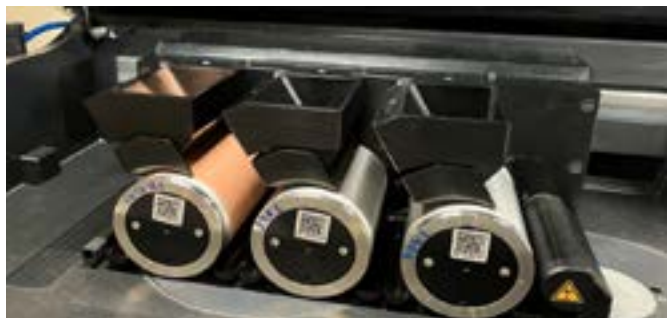
Le dispositif d'Aerosint permet de travailler avec jusqu'à trois matières sur la même pièce en fabrication additive.
