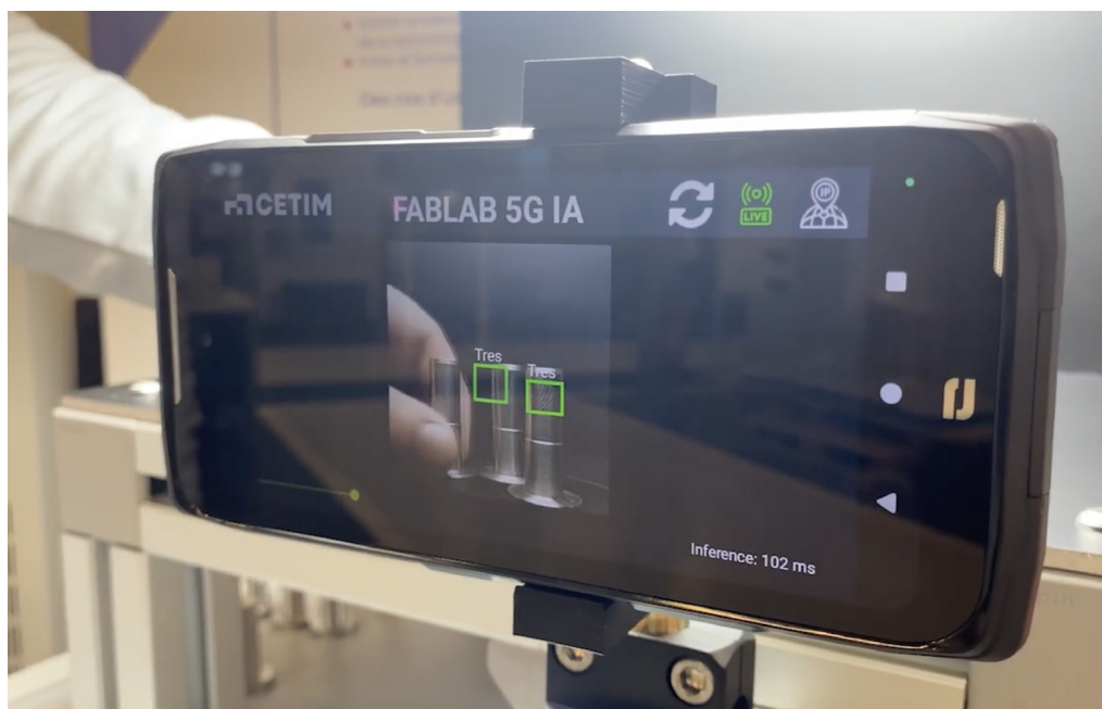
Le démonstrateur mis au point par le Cetim pour le contrôle d'aspect assisté par IA sur des pièces usinées en tournage utilise un téléphone 5G pour capturer les images qui sont traitées en temps réel sur un serveur à proximité du cœur de réseau.
