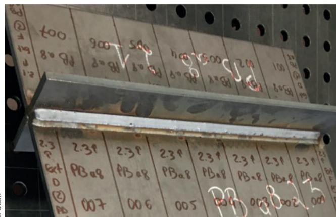
**Les assemblages.** une fois meulés, ont été découpés pour créer les éprouvettes à tester.
