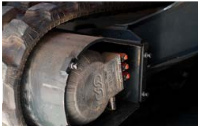
Le prototype est équipé de 4 moteurs. Un sur chaque chenille, un pour la tourelle et un pour les mouvements linéaires.
