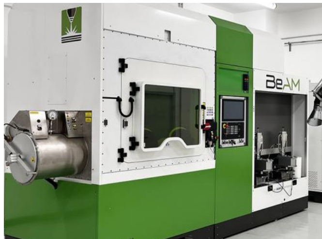
La technologie DED mise en œuvre sur cette machine permet de fabriquer et de réparer des pièces.
