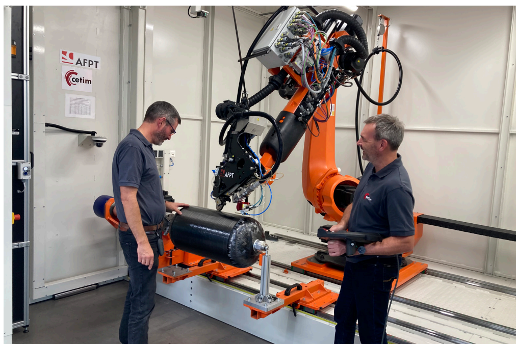
Le nouveau moyen HySPIDE TP du Cetim réduit considérablement les temps de production de réservoirs en composite.
