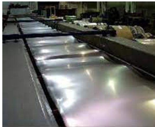
Exemple de flambage sous l'effet des contraintes
