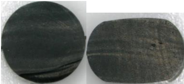
Section de joint avant et après vieillissement
