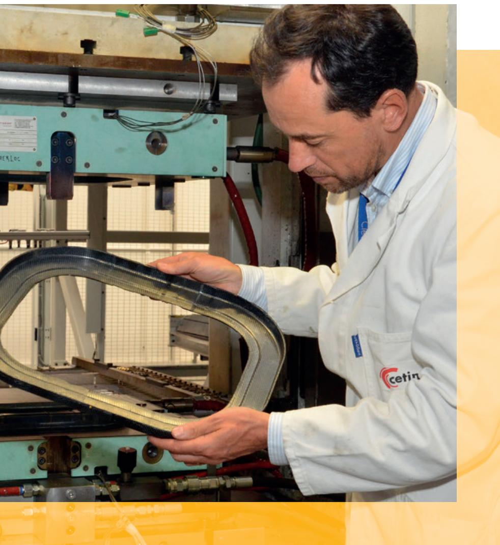
Production d'ensembles de hublot en PEEK et fibres de carbone par le procédé QSP du Cetim dans le cadre du projet européen Sherlock
