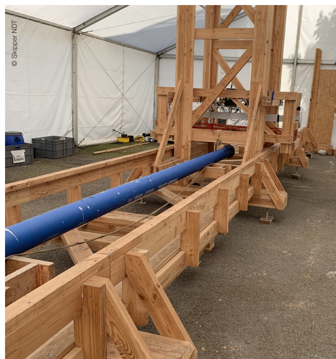
Des relevés magnétiques des différents types de défauts ont été effectués sur le banc d'essais de 20 m de long installé au Cetim.
