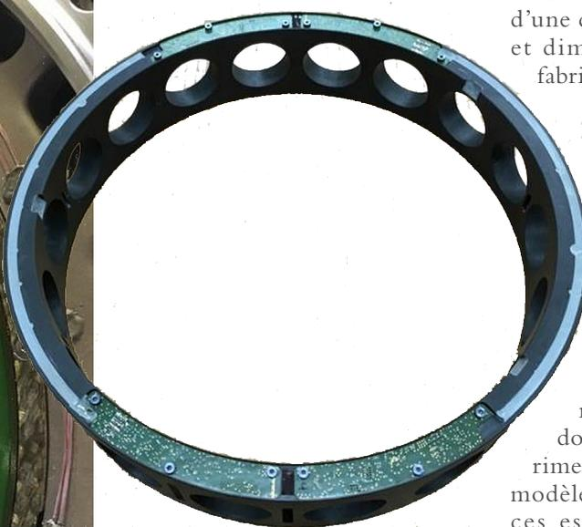
**Le défi relevé** par le Cetim : intégrer dans la bague en composite (ci-dessus) 6 jauges de contraintes, 16 capteurs de température et l'électronique de transmission sans fil des données.
