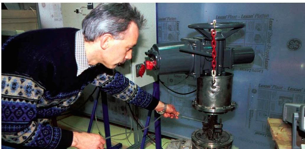
part, un essai type en vue d'une qualification complète du robinet et une classification en termes de performance; d'autre part, un essai de production visant au bon montage du robinet dans la ligne de fabrication.
