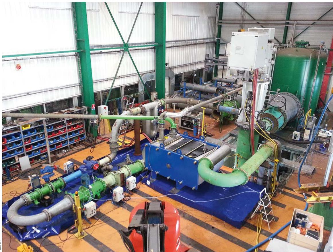
La boucle de test développée par le Cetim pour Eureka Pumps intègre un échangeur pour maîtriser en permanence la température du fluide et donc sa viscosité.
