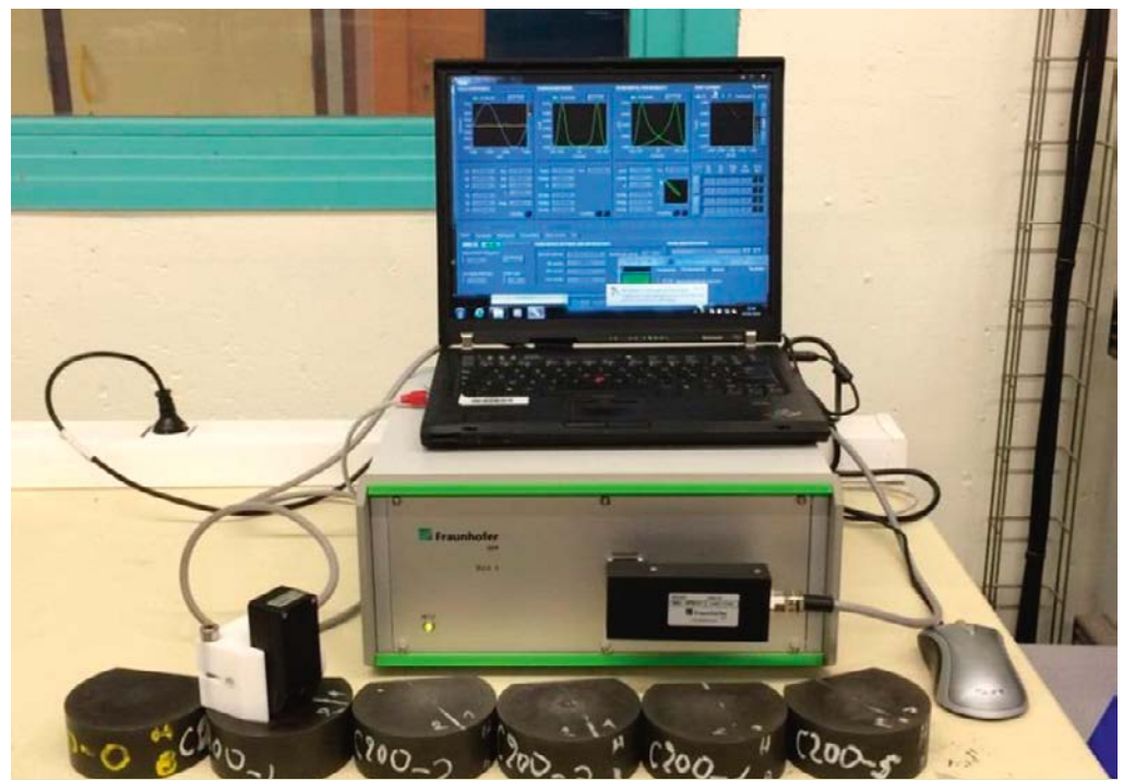
Les mesures de profondeur de traitements thermiques et thermochimiques ont été réalisées sur le système 3MA qui cumule plusieurs techniques électromagnétiques.
