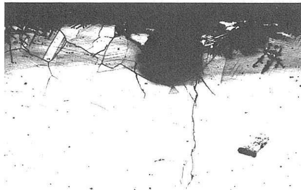
Cliché montrant l'amorçage d'une fissure de corrosion sous tension sur une piqûre.
