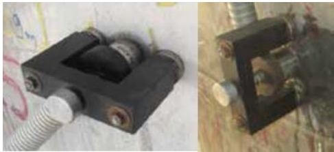
Montage des capteurs en paroi
