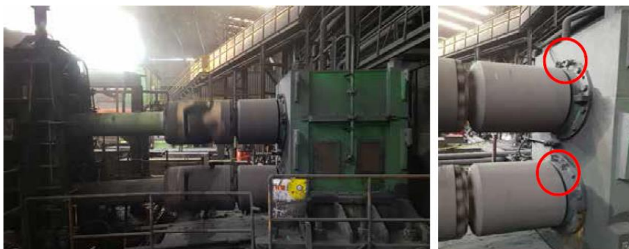
Implantation des capteurs EA sur le laminoir
