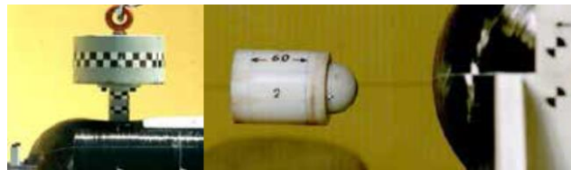
Configuration de crash. Gauche : tour de chute. Droite : canon pneumatique
