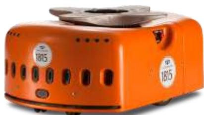
La robotisation propose ici un nouveau concept de stockage dynamique. Les robots qui cheminent dans les entrepôts n'ont rien d'humanoïdes mais prennent la forme de supports roulants qui viennent se placer sous les rayonnages où les manutentionnaires accèdent aux articles. Les robots sont alors capables de déplacer automatiquement le rayonnage et les articles qu'il contient pour les amener ensemble vers un atelier de colisage, par exemple.
