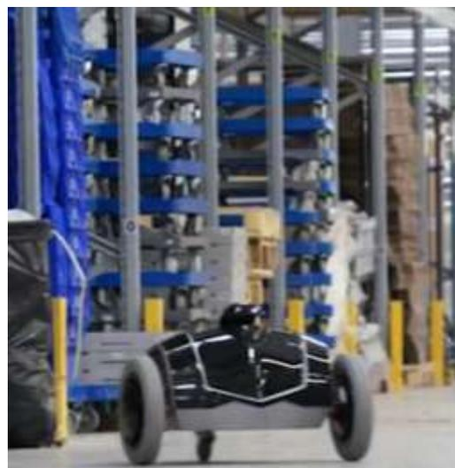
Capable de se déplacer à 10 Km/h sa plateforme mobile embarque à son bord de nombreux capteurs, une caméra infrarouge motorisée à 360°, des hauts parleurs et des microphones, ainsi que des moyens de dissuasion tels qu'un flash aveuglant et une alarme stridente. Il est équipé d'une connectique USB et est connecté à internet en Wifi. Il ne dépasse pas 25 centimètres de hauteur, dispose de plus de 7 heures d'autonomie et d'un système de recharge automatisé.
