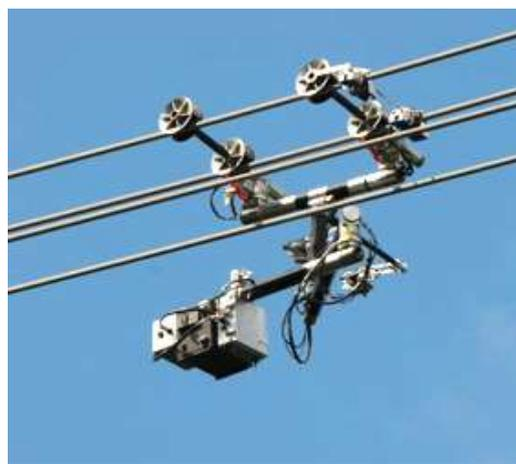
Le robot d'inspection Expliner du japonais HiBot roule le long de la paire supérieure du réseau de quatre câbles solidarisés par des entretoises tous les 30 m. Expliner a été testé sur des fils sous tension jusqu'à 500 KV. Il est muni d'un bras manipulateur servant de contrepoids lors du franchissement des attaches de suspension. D'une autonomie de 6H et télé opérable jusqu'à 700 m il porte des caméras qui peuvent contrôler le câble sur 360° avec une résolution de 0,1 mm.
