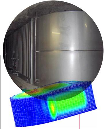
à l'espace disponible dans cette cave. Le logiciel nous a permis de réaliser le calcul de dimensionnement des parois du réservoir, de déterminer la meilleure méthode de construction possible et de faire une proposition chiffrée dans les meilleurs délais. L'intégralité de la note de calcul a été en outre vérifiée et validée par le Cetim. »
