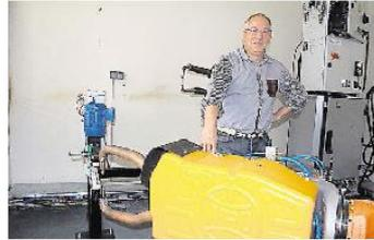
À Château-du-Loir, Philippe Chartrain avec l'une des pinces à souder robotisées d'Aro Welding Technologies. Cet outil est capable d'assembler une centaine d'éléments de tôlerie en 3 000 à 5 000 points de soudure.
