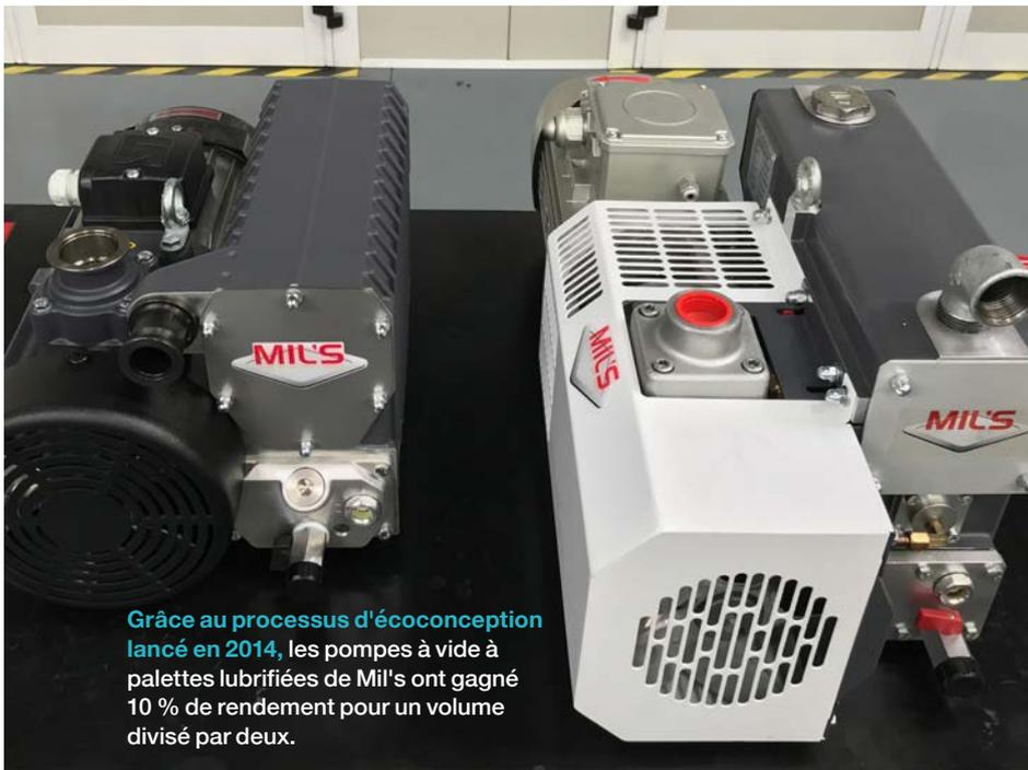
Grâce au processus d'écoconception lancé en 2014, les pompes à vide à palettes lubrifiées de Mil's ont gagné 10 % de rendement pour un volume divisé par deux.
