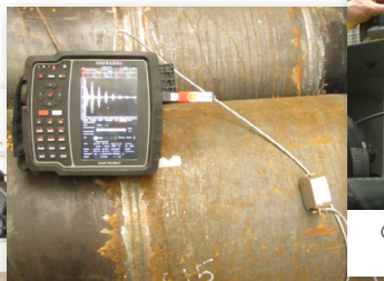
Contrôle de la soudure d'un ballon par ondes guidées par réflexion
