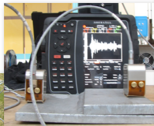
Contrôle d'une soudure à clin par ondes guidées par transmission.
