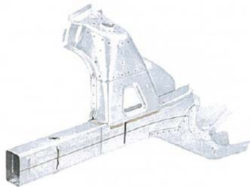
Sous-ensemble pour longeron en tube T3 prêt au soudage par points par résistance.
