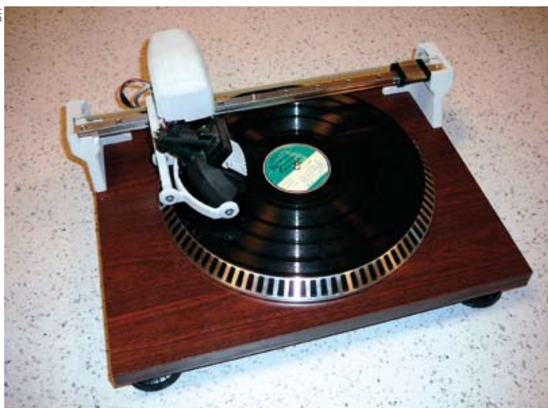
Un système mécatronique qui permet d'acquérir l'image du sillon par lecture sur le flanc.
